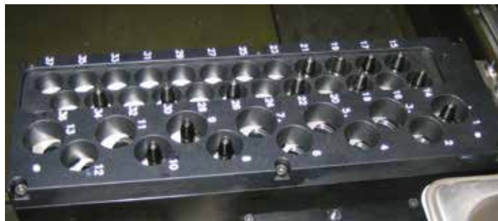
Рис. 9. Станция смены вакуумных захватов на 37 позиций в автомате SM482 Plus
