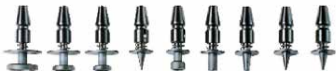
Рис. 20. Вакуумные захваты с керамическими наконечниками
