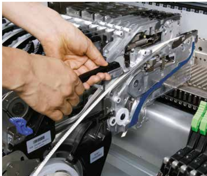
Рис. 33. Замена питателей без остановки автомата
