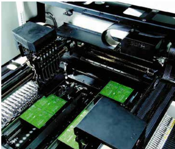
Рис. 32. Два независимых портала в автомате Hanwha
